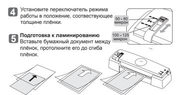
Вложите пленку закрытым концом прямо в ламинатор через входное отверстие. Проталкиваемая пленка должна коснуться вала, вал должен сработать автоматически.
