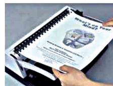
5. Оттяните назад Ручку перфорации/переплета так, чтобы пружина для переплета была разжата на достаточную ширину, и перфорированные листы могли быть легко на нее надеты.
